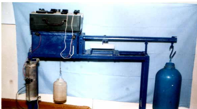
Рисунок 2. Общий вид устновки для измерения прочности при трёхточечном изгибе.
