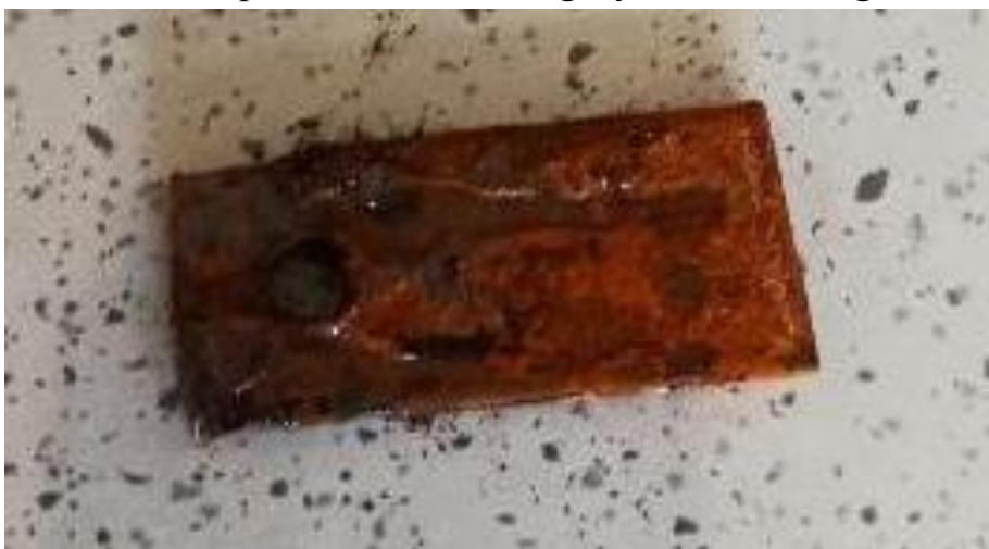
3B-rasm. St20 po‘lat namunasining ingibitorsiz texnik suv muhitidan keyingi holati.
