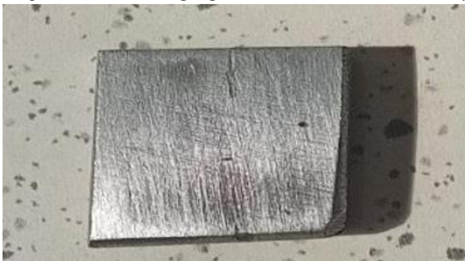
3C-rasm. St20 po‘lat namunasining ingibitor ishtirokidagi texnik suv muhitidan keyingi holati.
